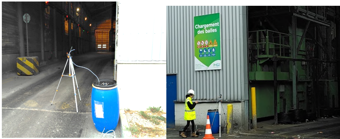
Figure 3-3: Prélèvement d'air ambiant aux ouvertures des portes du bâtiment de l'incinérateur (à gauche) et du centre de tri (à droite)
