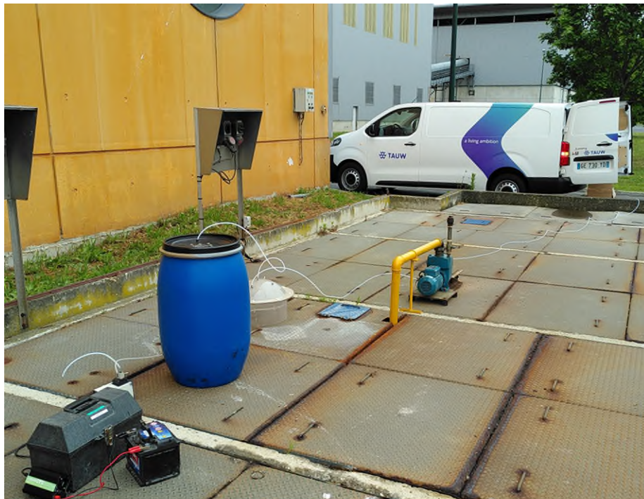
Figure 3-2: Prélèvement surfacique au-dessus de la cuve des eaux grises (prélèvement du ciel gazeux sur ces eaux)
