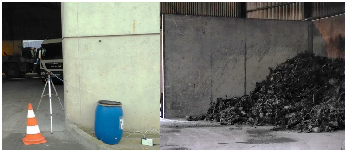
Figure 3-4: Prélèvement d'air ambiant dans le bâtiment du stockage des mâchefers
